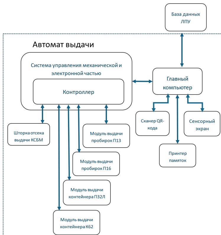
Рис. 2. Схема устройства автомата выдачи.
