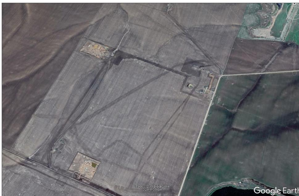
Рис 2. Сеть несанкционированных дорог на ключевом участке ОНГКМ, образованная водителями большегрузного нефтяного транспорта для субъективного удобства передвижения.
