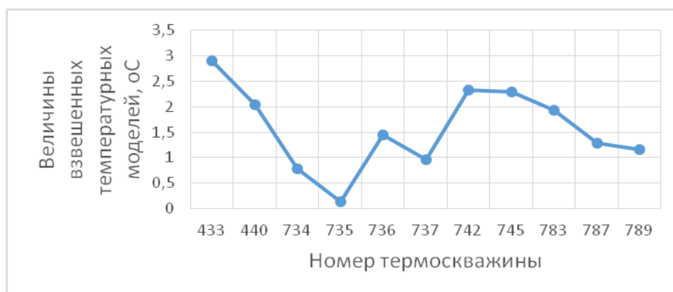
Рис. 3. График с величинами взвешенных температурных моделей термоскважин на участке трассы магистрального нефтепровода.
