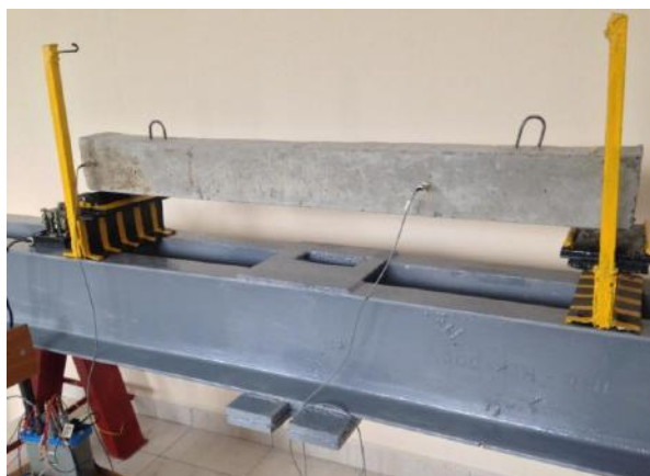
Рис. 4. Испытание целой ж/б перемычки.
