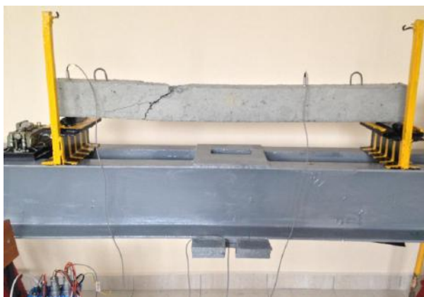
Рис. 3. Испытание нарушенной ж/б перемычки.
