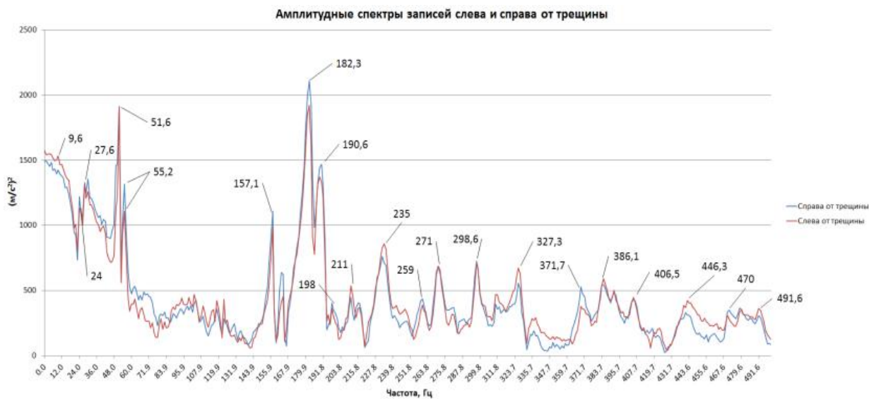
Рис. 6. Амплитудные спектры записей слева и справа от трещины.
