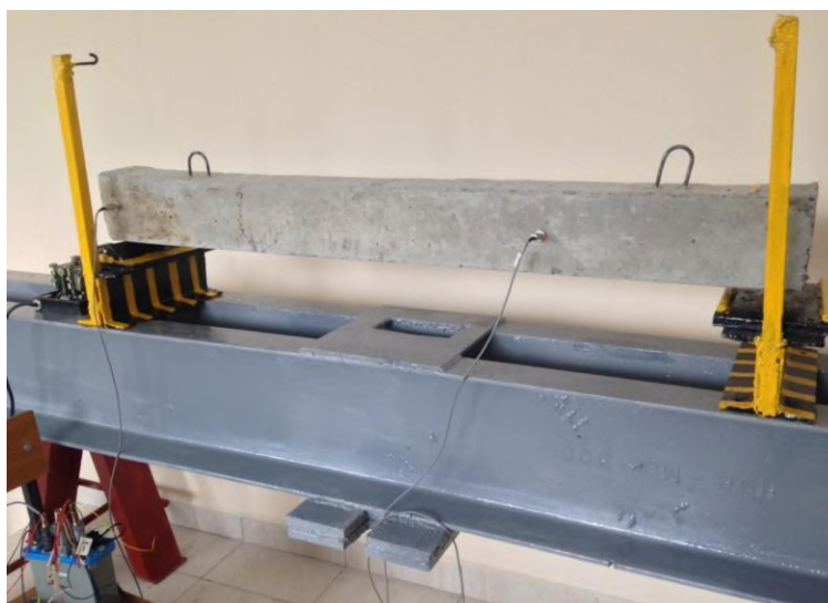
Рис. 2. Испытание целой ж/б перемычки.
