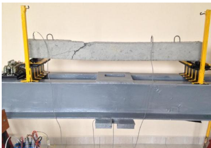
Рис. 1. Испытание нарушенной ж/б перемычки.
