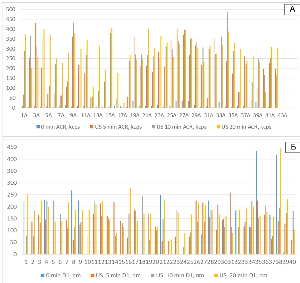
Рис. 1. Размеры частиц (первый пул частиц, D1) в супернатантах после инкубации имплантатов систем А (А) и В (Б) в бидистилляте в течение 5 суток без механического и физического воздействия (0 мин.) и после обработки ультразвуком частотой 35 кГц в течение 5, 10 и 20 мин.
