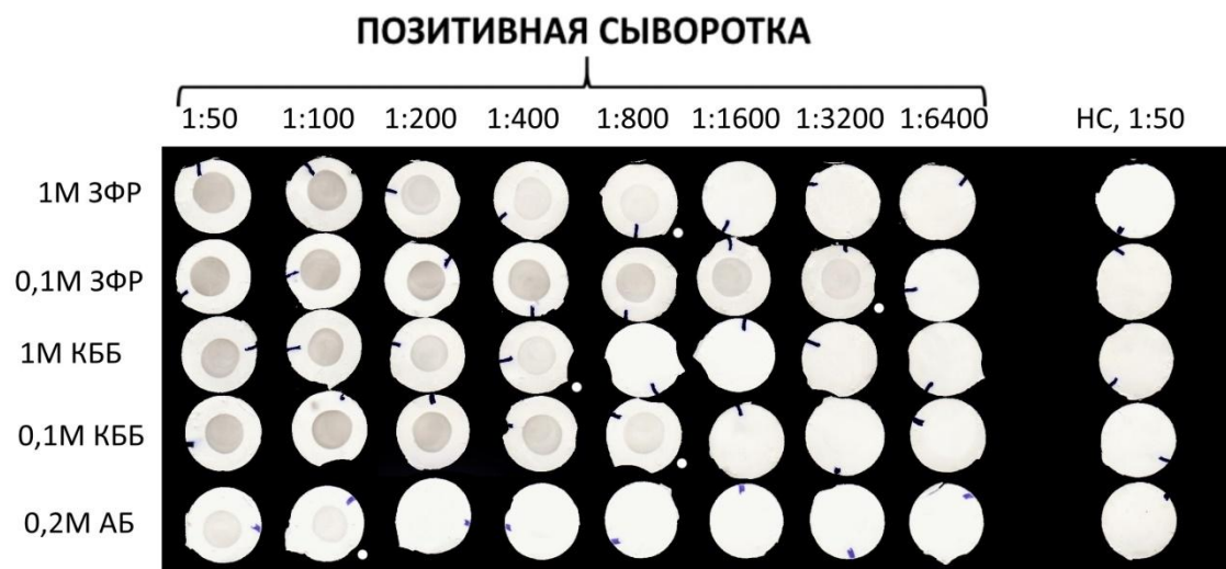
Рис. 3. Влияние различных буферных растворов на интенсивность сигнала в модельной тест-системе определения противокоревых антител.
