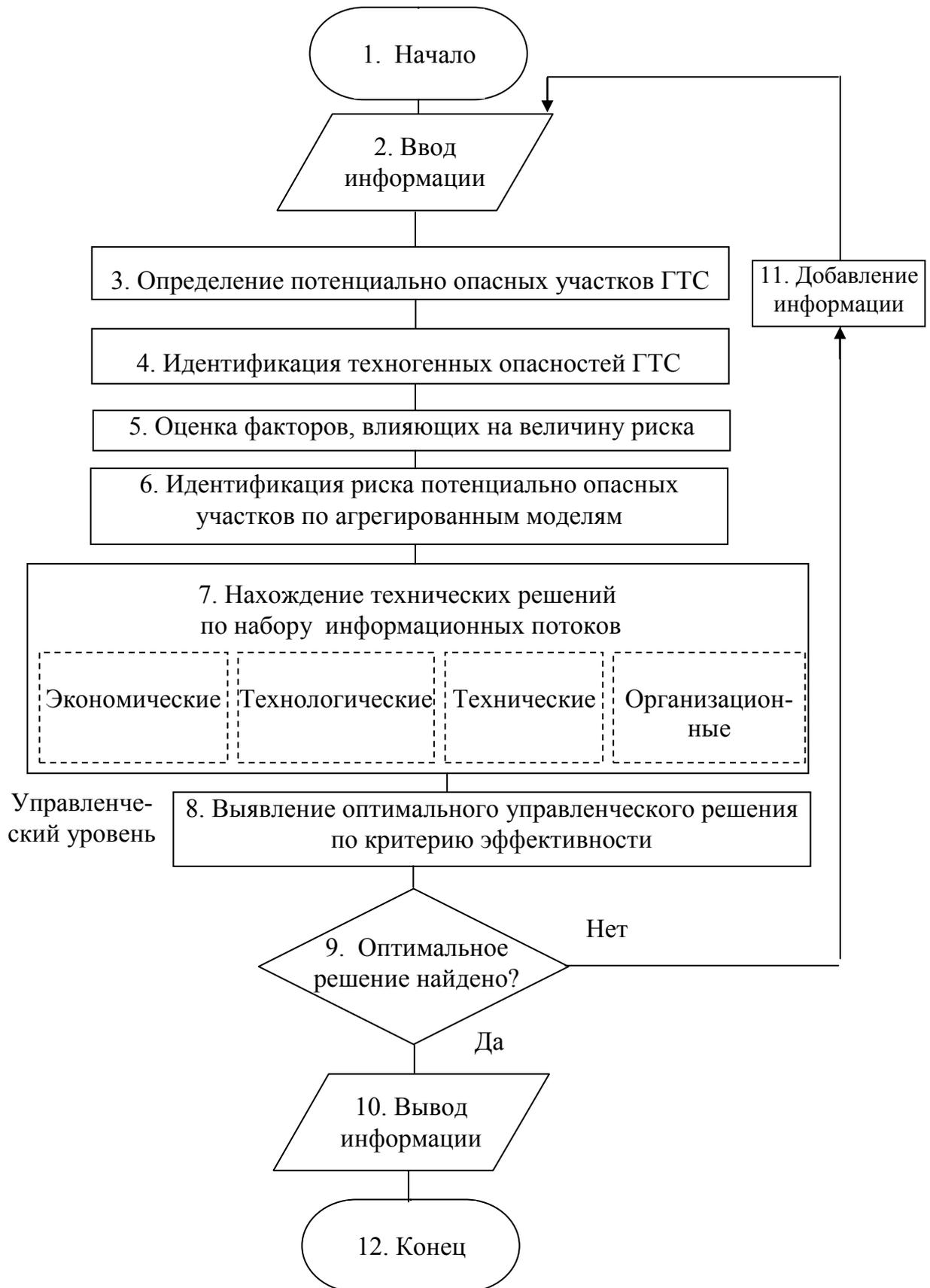
Рис. 2. Схема алгоритма нахождения оптимального решения для управления состоянием газотранспортных систем.
