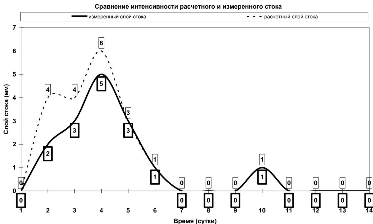
Рис.1. Сравнение расчетного и измеренного поверхностного стока.
